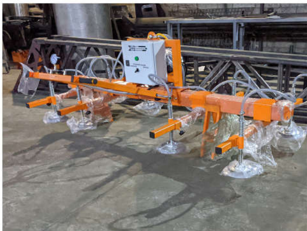
Опоры для хранения траверсы
