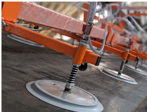
Краны отключения подачи вакуума на присоску
